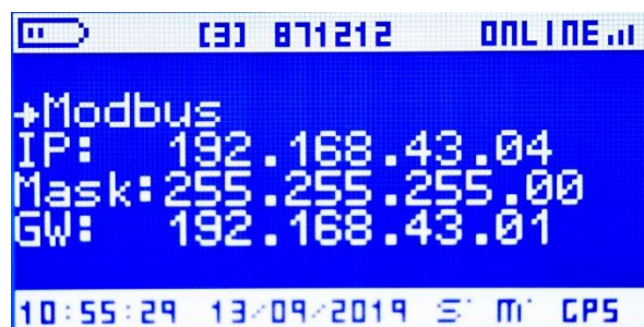
Fig. 36. STATUS screen: Modbus
